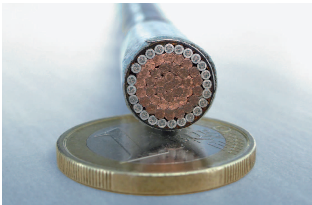
Foto eines Supraleiters, bestehend aus 24 MgB 2 -Drähten und einem Kupferkern, mit einem Durchmesser von nur 11 mm. Solche Kabel können Ströme von 10 kA und mehr transportieren.
